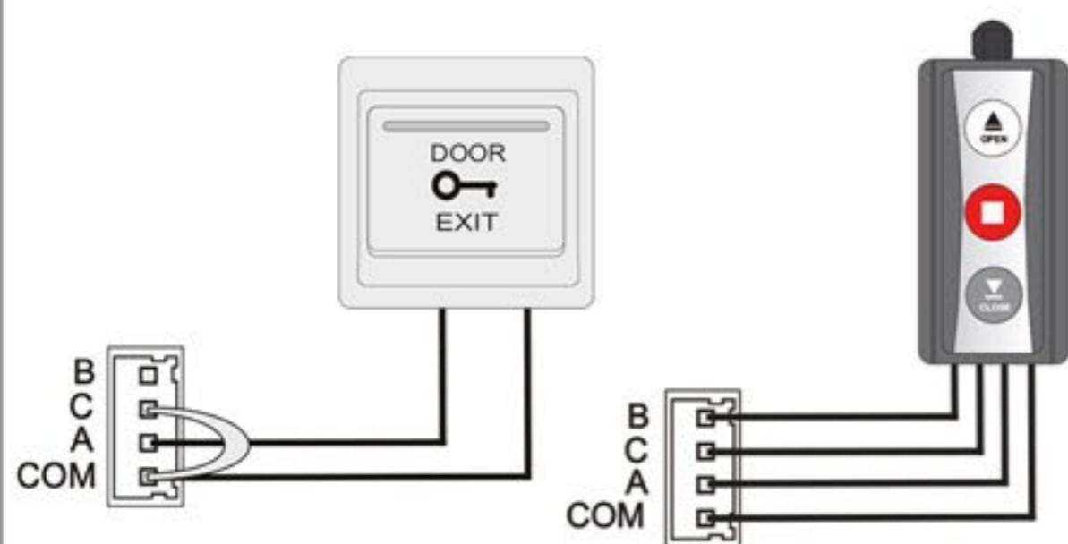
سوکت تحریک دست بر حسب 1-CH و 5-CH بودن مرکز کنترل، عملکرد متفاوتی خواهد داشت. اگر مدار در حالت 5-CH است یعنی ON:DIP3، دو پایه مشترک (COM) و بالا (A) را به کلید فشاری متصل نمایید. اما در صورت OFF بودن دیپ سوئیچ 3، عملکرد مدار 1-CH خواهد بود و برای کنترل مدار می‌توان از کلید سه حالت (بالا - ایست - پایین) استفاده نمود.
